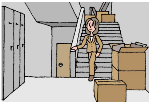
避難障害及び可燃物となる物品が置かれている
